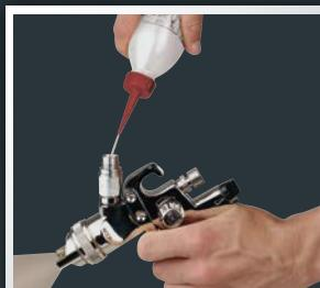
DE Abzugsbügel betätigen und gleichzeitig Reinigungsmittel zuführen. Bis zur vollständigen Reinigung fortsetzen.
